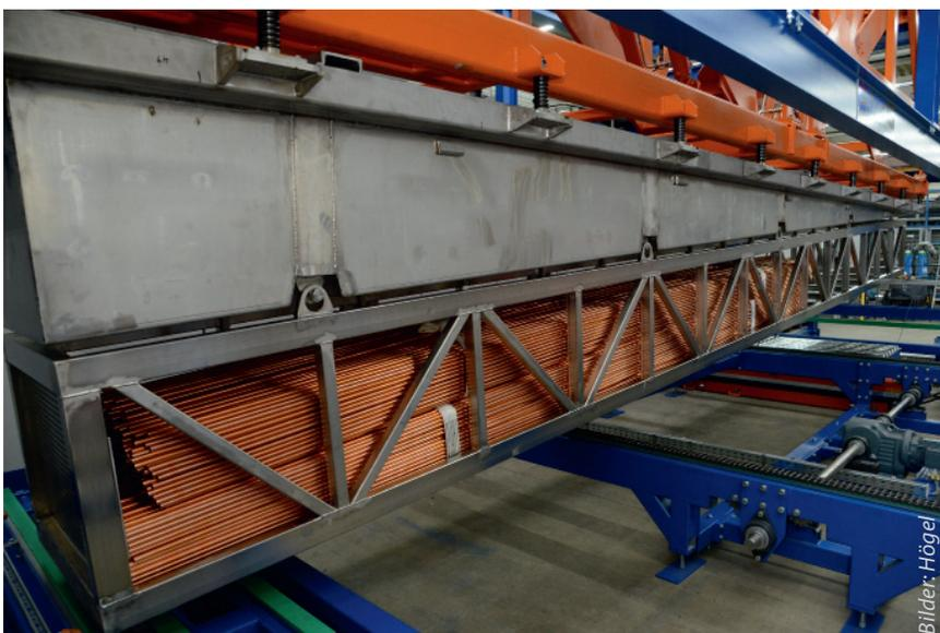
Die Neigung des Warenkorbs unterstützt die Reinigung und ermöglicht schnelles Entleeren der Kammer
