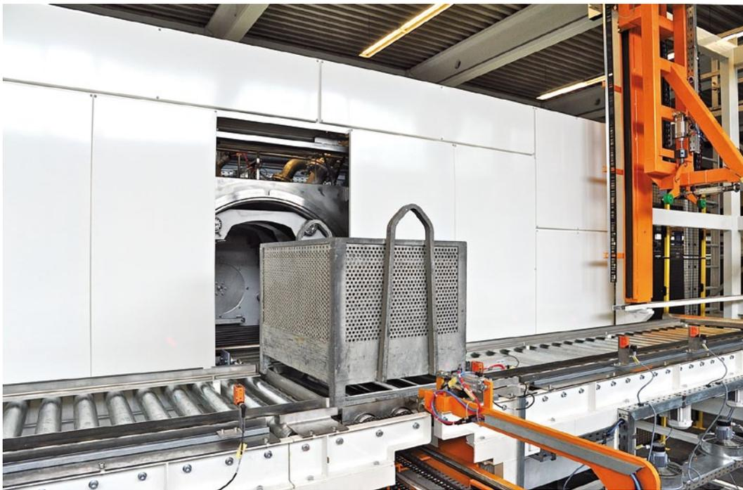
Die Teile werden in der Anlage mit flüssigem Perchlorethylen grob gereinigt beziehungsweise entfettet, danach mit Lösemitteldampf feinentfettet und anschließend im Vakuum getrocknet
