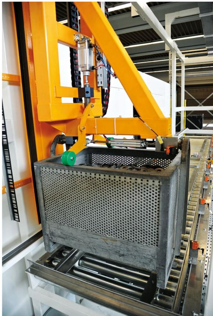
Ein Portal mit Spezialgreifer setzt den Korb auf der in rund 1,5 Meter Höhe angebrachten Zuführ-Rollenbahn der Anlage ab
