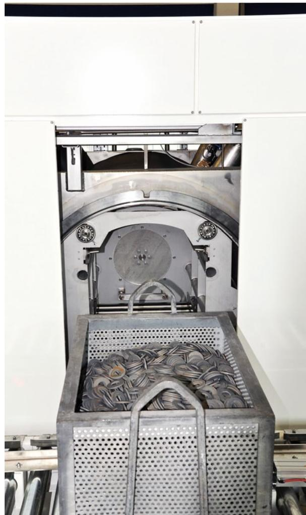
Gereinigt werden die Teile in 850 x 600 x 750 Millimeter großen Warenkörben als dicht gepacktes Schüttgut
